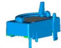
Вставка XE 51: защелка закрыта
